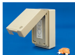
■露出鍵付スイッチ【特許出願済】 ■露出スイッチ【特許出願済】 単独操作と SM1、CD4 スwitchの外観は同じです。(結線方法は異なります) 陽光センサー付きの場合は、別途専用スイッチとなります。 露出タイプ、鍵付タイプのほかに埋込みタイプもございます。
